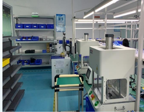
Airtight test machine
